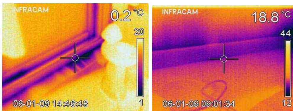
Figur 10 Termograferingsbilder (lila är kallt och vitt är varmt). Till vänster visas hur det drar vid en altandörr och till höger vid en golvlister. Vid altandörren är det endast 0,2 °C.
