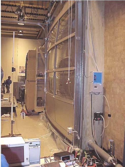
Figur 18 En stor port täthetsprovas på laboratorium. Många gånger provas hela fasadelement med fönsterinfästningar, genomföringar, skarvar m m.
