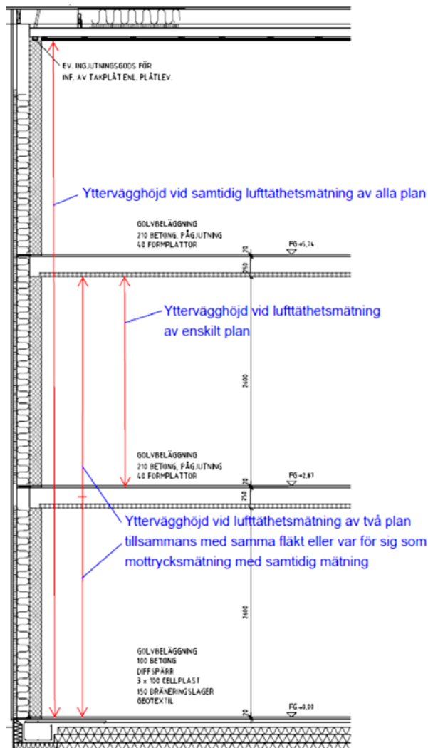
Figur 6.4. Ytterväggshöjd som får medräknas till omslutningsarea vid lufttätetsmätning av ett respektive flera plan. Figuren är ett vertikalsnitt men principen gäller även horisontalsnitt vid provning av lägenheter.
